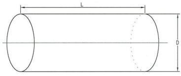
1,确认油枕外形尺寸 长度(L),直径(D)
